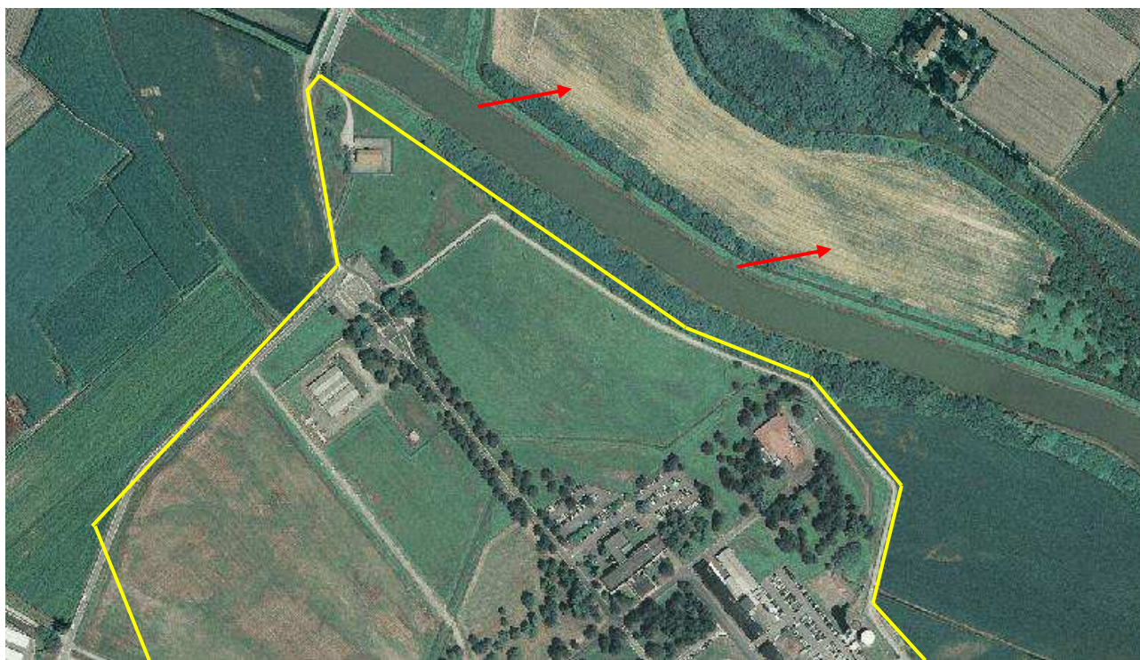
Dettaglio della porzione N dell'area di intervento (le opere a progetto sono evidenziate in giallo). Le anomalie visibili, indicate dalle frecce rosse, sono riferibili a divagazioni dei vicini corsi d'acqua.
