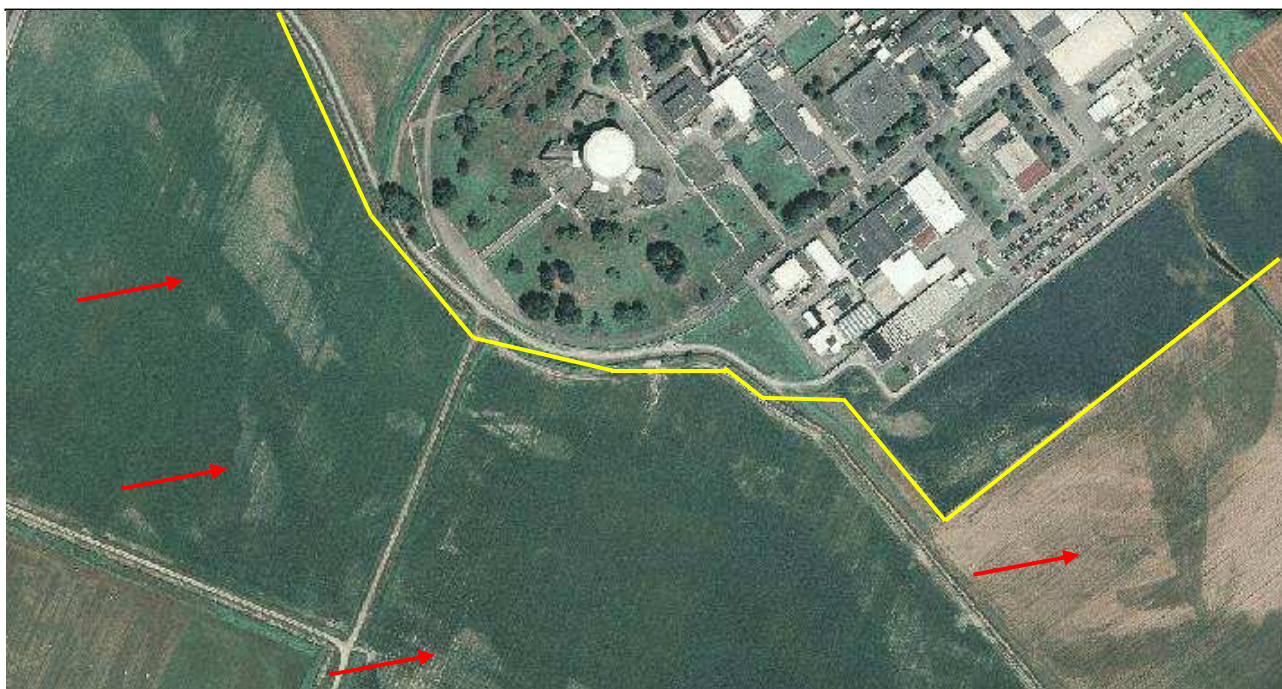
Dettaglio della porzione SW dell'area di intervento (le opere a progetto sono evidenziate in giallo). Le anomalie visibili, indicate dalle frecce rosse, sono riferibili a divagazioni della Dora Baltea.
